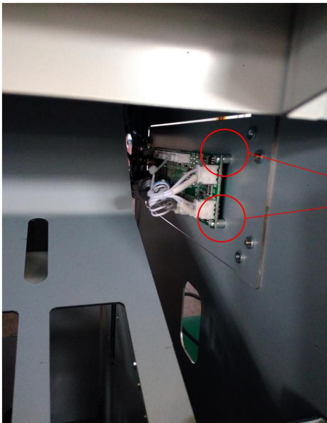
从打印机的后面卸掉后面两颗固定螺丝
