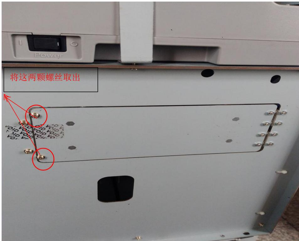
3、打开切刀控制板安装侧板，切刀控制板 4 个角上用 4 颗螺丝将控制板固定在钣金侧板上。取出螺丝就可以取下控制板，接线上标有插口标识和控制板上插口形成对应关系，安照对应进行连接。如果插线上没带标识的情况下建议将原控制板上插口拔一个插一个到新板子上，这样不容易出现错误。更换完板子后，按照原来的安装情况进行复原。
