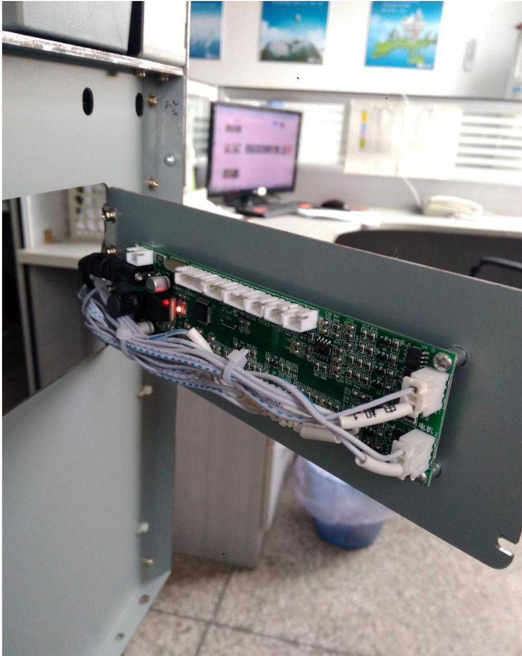
4、简易处理方式，由于打印机在机柜中，体积大，重量重，因此在不进行拆卸出机柜条件下也是可以进行操作的，只要先到打印机前面把控制板上的两颗固定螺丝卸下，再到机柜后面，从打印机的后面把另外两颗固定螺丝卸下，打印机的切刀控制板也是能进行更换的。如图所示，具体我也不多说和上面的基本一致，相信大家都明白怎么更换了吧。
